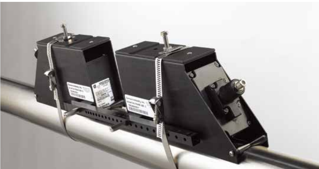
SITRANS FSS200 外夹式超声波传感器易于安装，由于不会与介质接触，几乎不需要维护。
